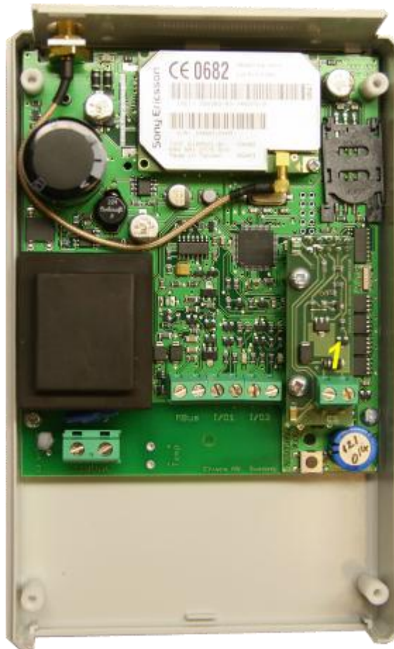
Figur 6. ECO E10 utrustad med CS-kort för 61107-mätare med strömslinga
